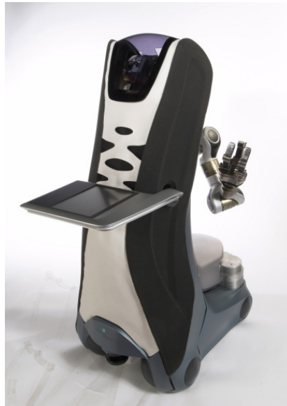
Haushaltsassistent Care-O-bot 3 Fraunhofer IPA Stuttgart
